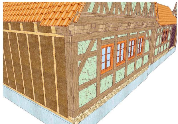
das 6 cm dicke Sichtfachwerk wird von der Rückseite verschraubt, rechts mit Ausfuchung
